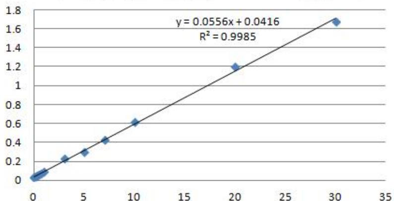
注意：由于检测仪器和操作手法等条件的不同，参考值范围会有波动，该值仅供参考，对于要求精确计算 Glu 含量的，可以采用标准曲线进行多点测定；根据测定经验显示，标准品浓度在 0.1mmol/L 以下，30mmol/L 以上，标准曲线会有偏差。
