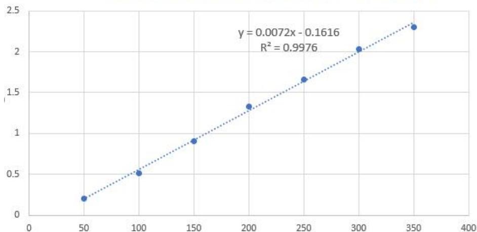
采用酶标仪 540nm 测定，“0”号管吸光度为 0.14 左右，呈黄色，100 $\mu\text{g}/\text{ml}$ 以上呈棕红色并逐渐加深。测定结果显示，当葡萄糖浓度大于 350 $\mu\text{g}/\text{ml}$ 时，OD 值开始偏离，当葡萄糖浓度在 100~250 $\mu\text{g}/\text{ml}$ 以内比较合适，因此当测定结果明显偏高应稀释后再测。因测定仪器及操作手法等不同，测定结果可有一定偏差。
